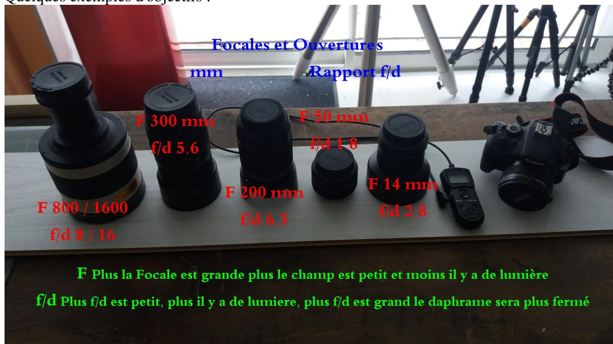
Les focales 50 mm à 14 mm sont réservées pour les plans très larges, elles ne nécessitent pas forcément d'un suivi ou d'une **table équatoriale** motorisée. \*
